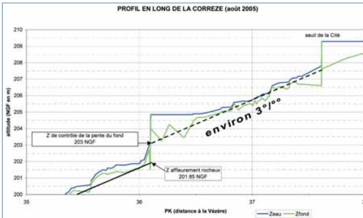
↑ **Figure 39** : Etude du profil en long d'un cours d'eau pour en déterminer la pente d'équilibre et les cotes optimales d'arasement de seuils. On voit bien ici que le « remous solide » (trait vert) généré par un seuil ancien (ici au moins 2 siècles) va bien au delà du remous liquide (trait bleu) (source : Malavoi, Biotec, 2005). 🌊
