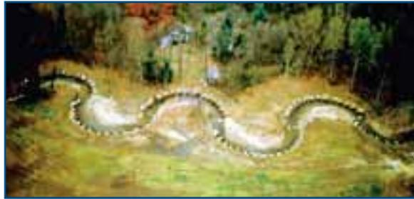
↑ **Figure 93** : Exemple de tracé sinueux trop régulier, qui de plus est destiné à être figé (seuils au droit des points d'inflexion + protection de toutes les berges concaves). ≈
