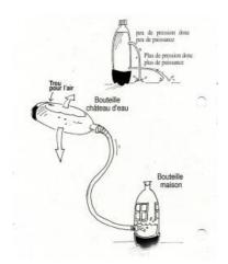
L'eau qui coule du robinet vient souvent d'un réservoir ou du château d'eau : cette expérience permet d'en comprendre le principe.
