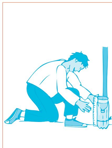
Colle la graduation sur la partie inférieure de la bouteille, le 0 correspondant au fond de la bouteille. Pose ta bouteille à l'extérieur à un endroit exposé à la pluie, en veillant à ce qu'elle ne tombe pas.
