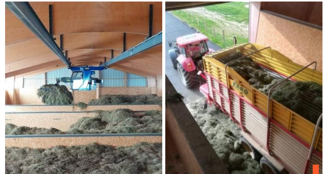
Séchoir à foin bâtiment intérieur Autochargeur pour ramasser et charger le foin automatiquement
