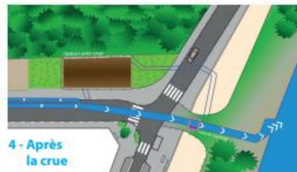
Lorsque le niveau du cours d'eau est revenu à la normale, la vanne s'ouvre. Les eaux de pluie s'écoulent de nouveau naturellement et ne passent plus par la station anti-crue.
