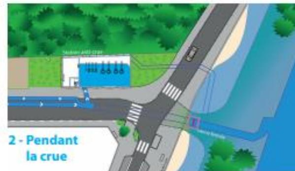
La vanne anti-crue se ferme, empêchant le cours d'eau de remonter dans le réseau d'assainissement. Les eaux pluviales sont dirigées vers la station anti-crue.
