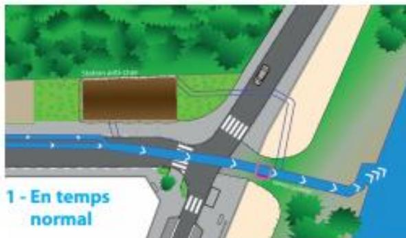
Les eaux pluviales sont rejetées directement dans le cours d'eau par le réseau d'assainissement.
